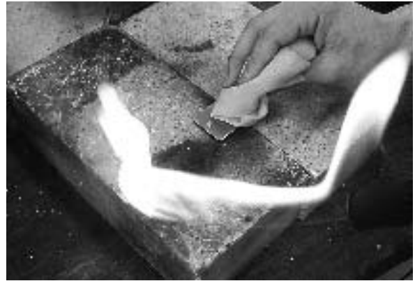
図 12 火で炙り絹を押し付ける
