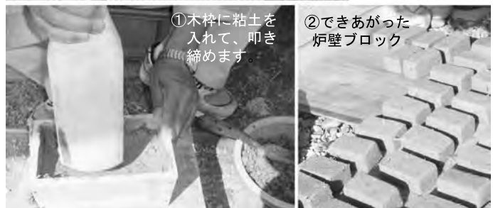
写真4 炉壁ブロックづくり
