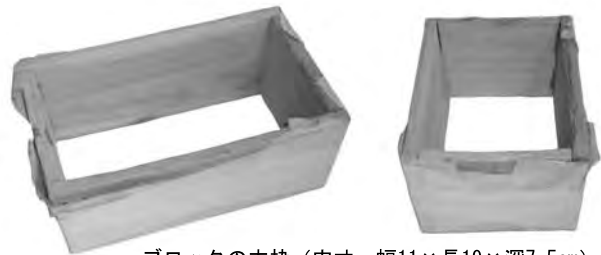
ブロックの木枠（内寸：幅11×長19×深7.5cm）
