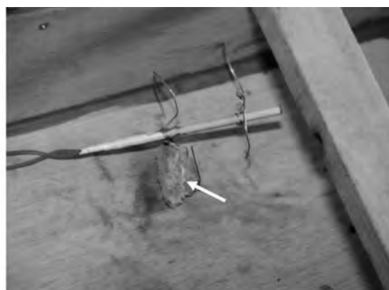
(b) 鞆の風量測定センサ
