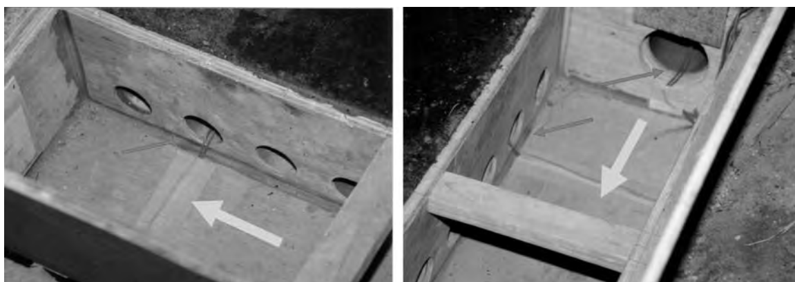
写真2 風箱内での圧力センサーの設置位置（太い矢印が風の方向、細い矢印がセンサーの設置位置）
