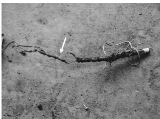
(a) 17 番目羽口の送風量測定センサ
