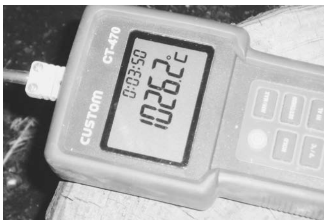
写真 12 鍛冶炉内の温度
