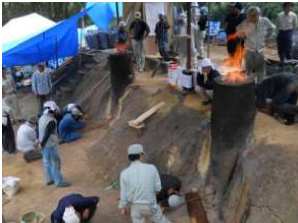
写真2 豎形炉の操業実験
