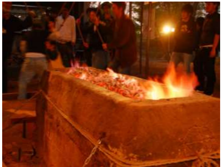
写真1 箱形炉の操業実験
