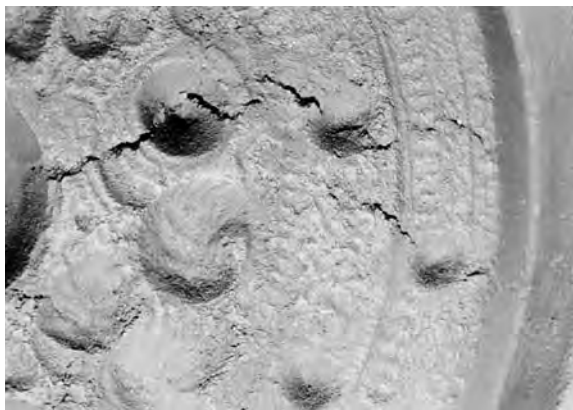
図4-19 鑄型Uのひび
