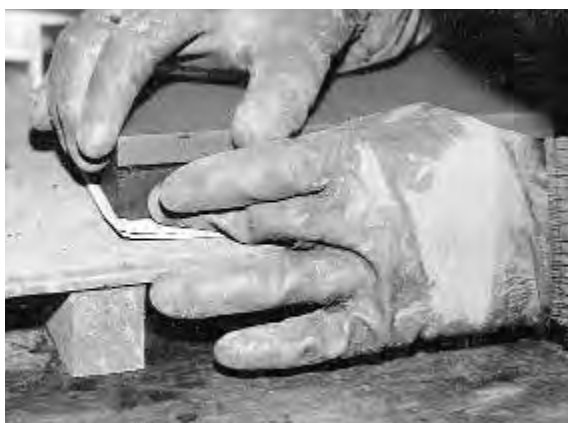
図 2 - 10 鋳型と原型を剥離する
