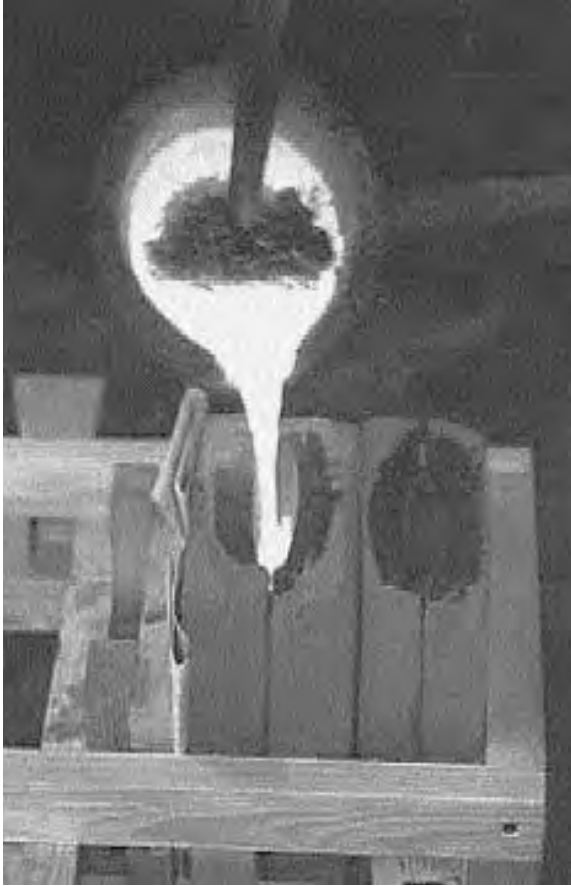
図3 - 38 原寸大鋳型への鋳込み（左二層式、右一層式）
