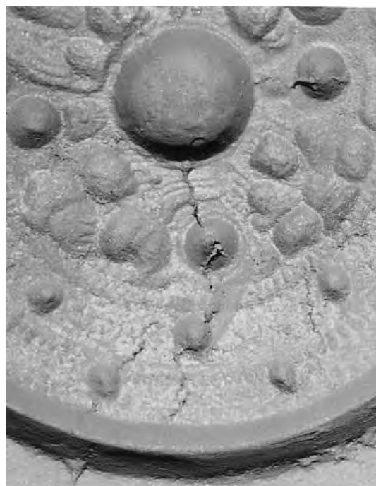
図3 - 25 ひびが入った二層式鋳型の表面（鋳型U） 上段と下段左は、乾燥後・焼成前、下段右は乾燥・焼成後
