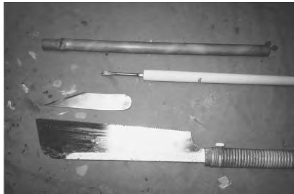
写真7 素材の篠竹と加工用具 (ねずみ刃錐・切り出し・ノコギリ)
