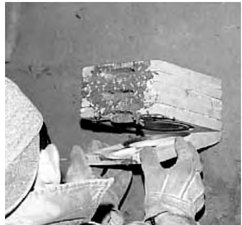
図3-11 鑄型の取り外し
