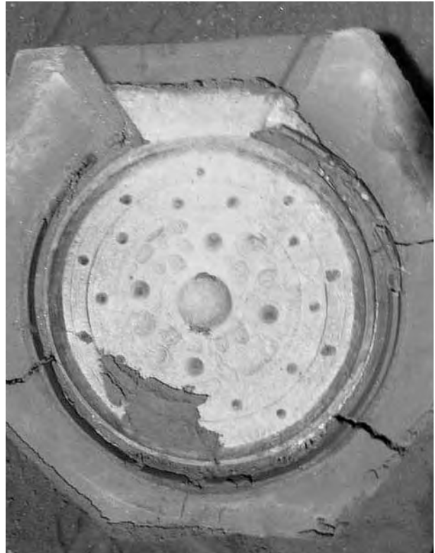
図3 - 41 復元した原寸大鏡（鋳込み直後）
