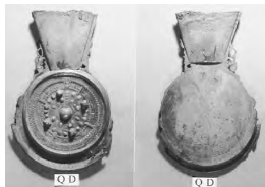
図5 QD鑄型による同範鏡の外観（970 鑄込み）
