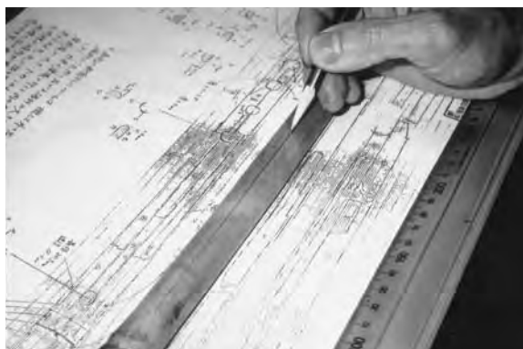
写真8 寸法図を基に各孔の位置を決める
