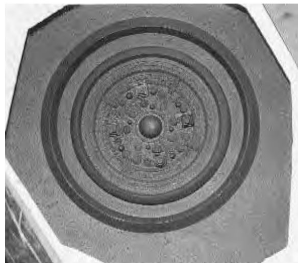
図 2 - 11 原型と剥がされた鋳型
