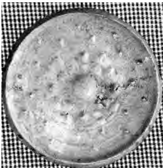
図3 - 34 U 1 鏡（二層式鋳型による）
