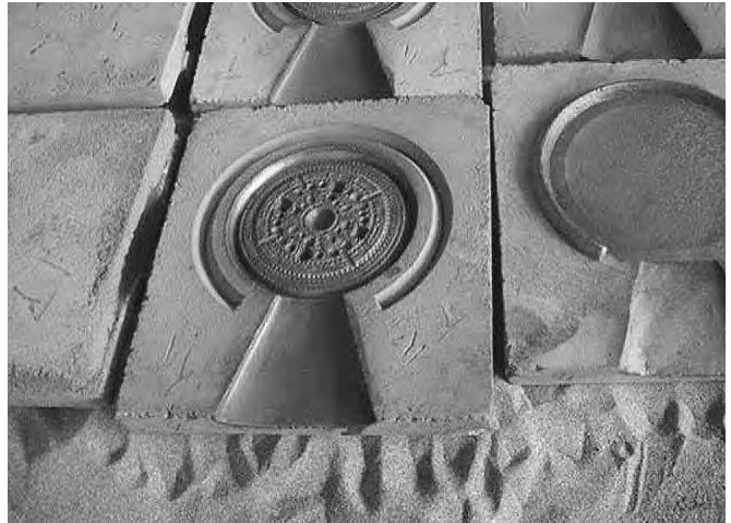
図3 - 2 黒鉛を塗って乾燥中の鋳型
