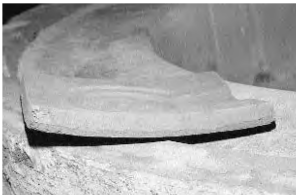
図3-23 パイメタルのように湾曲した二層式鋳型
