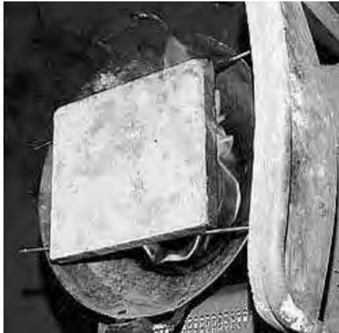
図3 - 1 油煙を着けている鋳型
