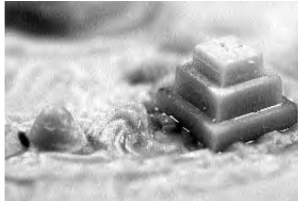
図2 - 5 抜きの勾配3.1度（垂直に近い）の突起
