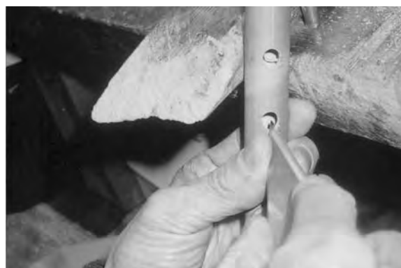
写真10 切り出して孔を整形する
