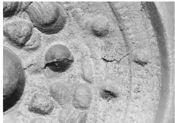
図4-20 鑄型Uのひび
