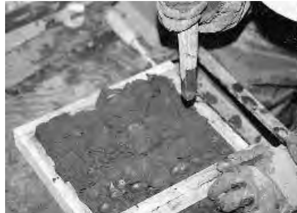
図 2 - 9 突き棒で突く
