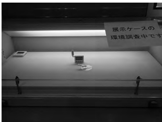
写真3 常設展示室簡易ガス濃度測定状況
