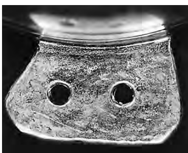
写真116 脚部の孔加工
