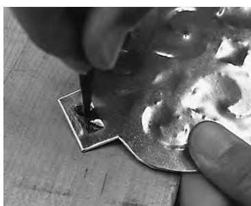
写真55 孔の中の金銅板を鑿で切断する
