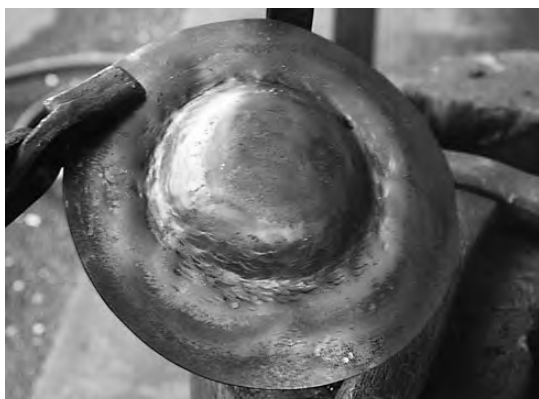
写真17 本体半球形部分の絞り加工
