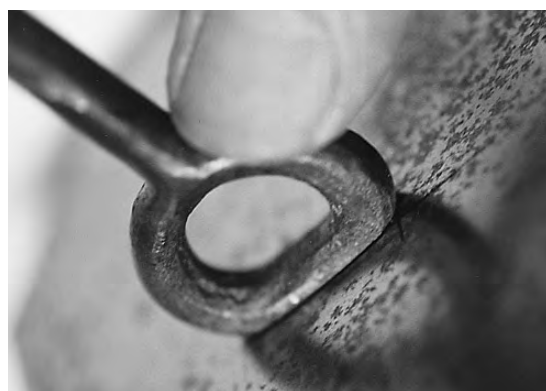
写真12 鏡板裏板との接合
