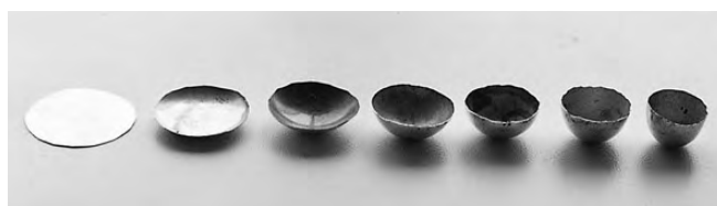
写真5 金銅板を半球形に打ち出す
