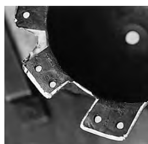
写真108 脚のコーナーは地金にを寄せて被せる
