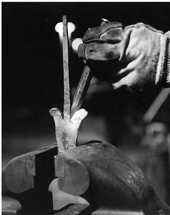
写真17 たがねで切り込み部分を押し広げる
