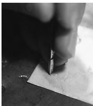
写真7 鉛板上で金銅板に文様を刻む
