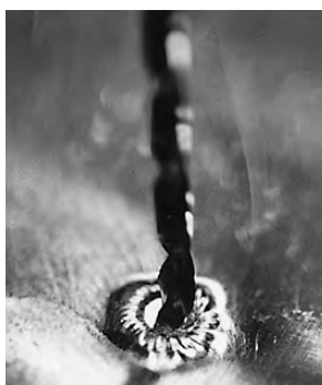
写真13 ドリルで孔加工する
