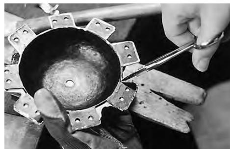
写真111 時計方向に脚を半分被せたところ
