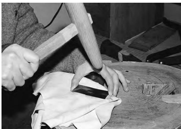
写真5 鉄板を木槌で軽く打出す。
