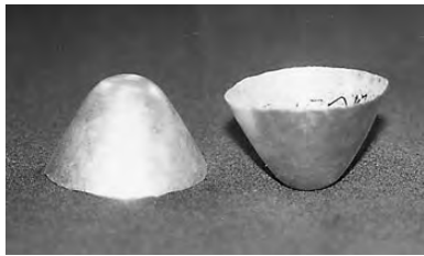
写真152 17回目の絞り加工
