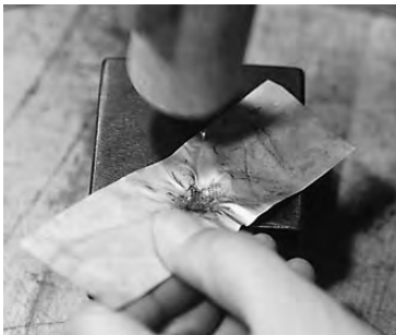
写真67 反った地金を平にする
