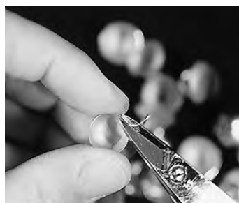
写真168 半球形の縁を切断する
