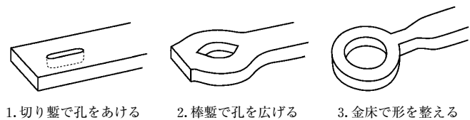
図3 打ち抜きによる輪環の製作工程
