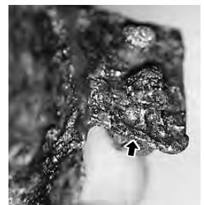
写真18 脚の裏面（折り返しが見える）
