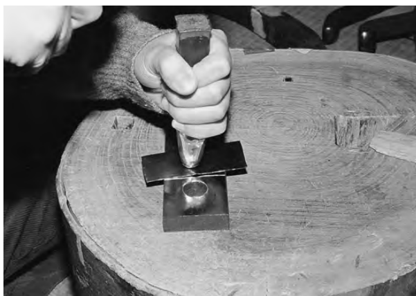
写真7 鉄製の鑿で打出す。
