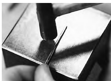
写真20 パイプを回転させながら叩く
