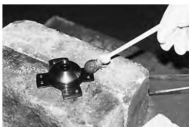
写真28 辻金具に漆を塗る
