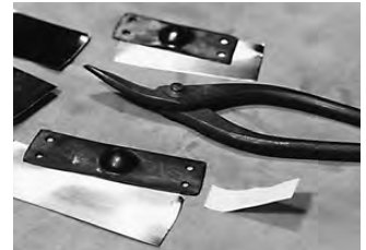
写真62 金銅板を切断する
