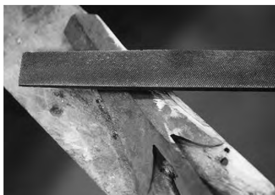
写真19 ヤスリでの整形
