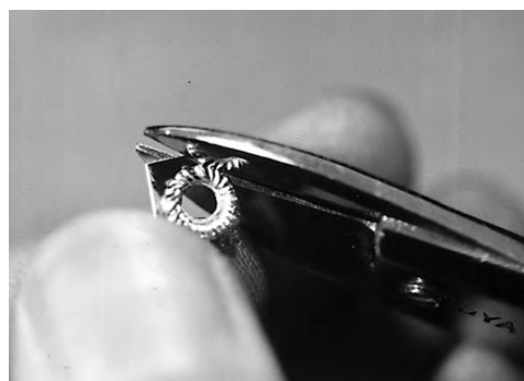
写真15 金鋏で円形に切断する
