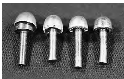
写真170 鉄頭に金銅板を被せる工程
