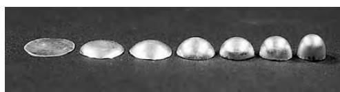
写真165 打ち出しの工程
