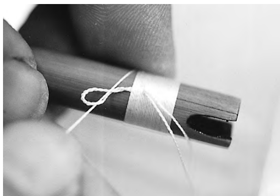
写真27 絹糸の補強巻き
