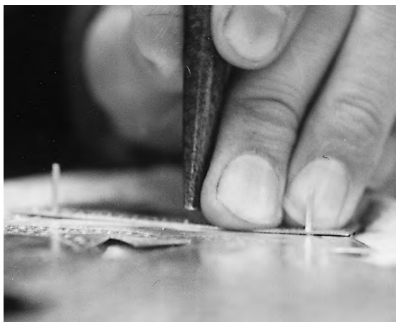
写真12 打ち鑿によるかしめ工程
