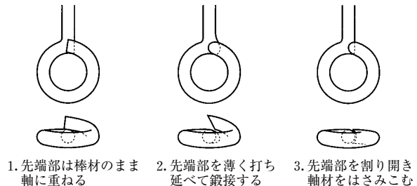
図5 棒材を先端部を軸に重ねる実験工程
