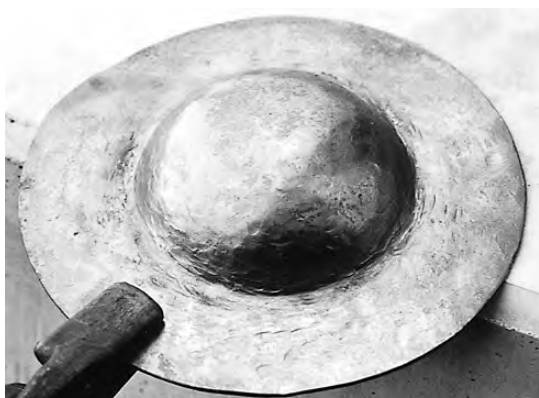
写真19 脚部分を平らに整形する
