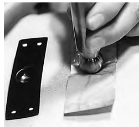
写真65 凹みに合わせて鑿で打ち出す
