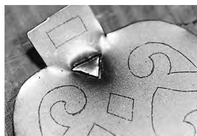
写真6 切断鑿で透かす（表面）
