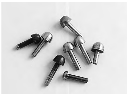
写真12 鋇頭部を研削して完成
