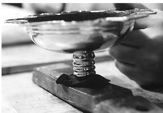
写真34 鉛台の上に固定する
