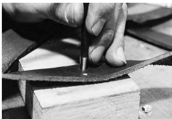
写真7 革帯への孔加工
