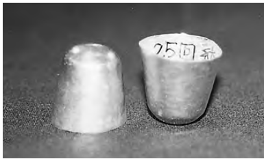
写真154 25回目の絞り加工
