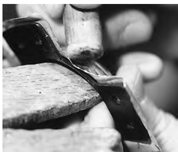
写真142 脚の間の金銅板を延ばす
