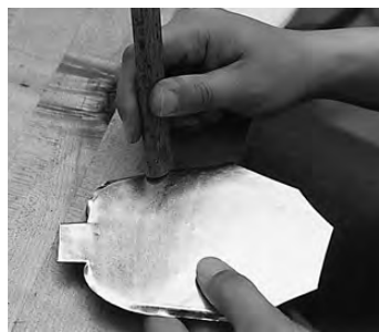
写真51 表から透かし板の文様を写す
