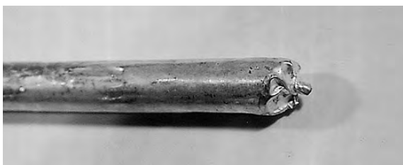
写真10 銀箔の端部固定
