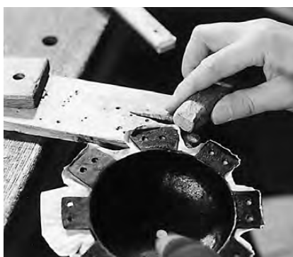
写真103 金銅板を側面に折り返す
