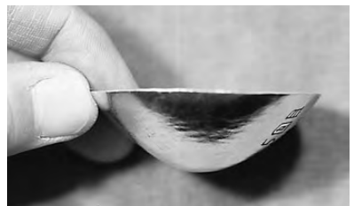
写真150 5回目の絞り加工
