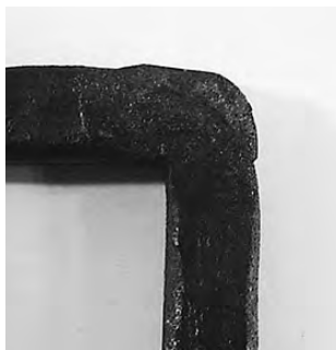
写真2 単純な曲げ加工
