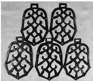
写真40 漆の焼き付け塗装を行なう
