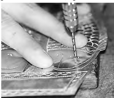
写真26 ドリルで孔加工する
