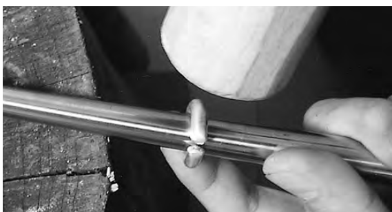
写真12 鉄棒を用いた環状成形
