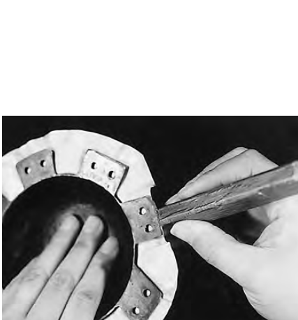
写真100 脚部の仮留めをする
