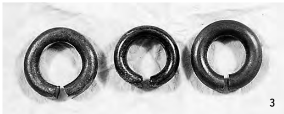
写真1 銅芯のスパイラル状曲げ加工
