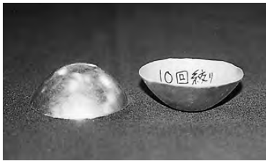
写真151 10回目の絞り加工
