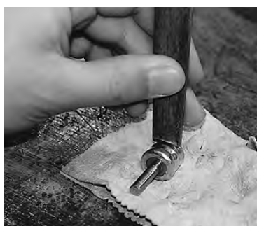
写真161 木槌で沈線を押し込む
