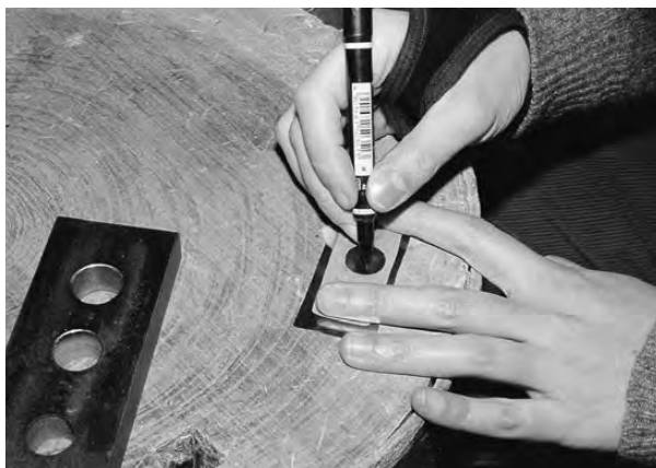
写真4 打出しの位置を鉄板の裏面に印す。
