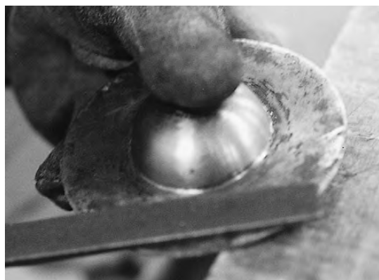
写真20 ヤスリによる打痕の処理
