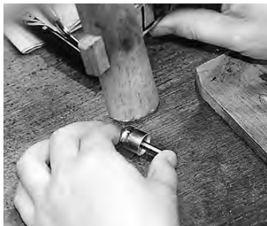
写真158 沈線の押し込み作業
