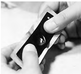
写真63 金銅板を鉄地に馴染ませる
