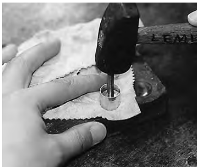
写真157 鉛台で鉄地の頭を打ち込む
