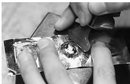
写真70 ヘラで金銅板をさらに密着させる
