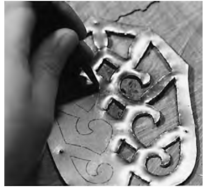
写真36 切断中の透かし板
