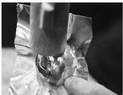
写真136 当て金で半球形の側面を絞る
