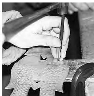
写真29 鑿でパイプの先端を開く
