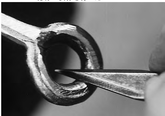
写真43 キサゲによる仕上げ
