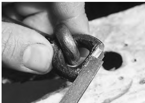
写真44 ヤスリによる削り出し
