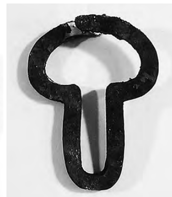
写真6 U形部の曲げ加工
