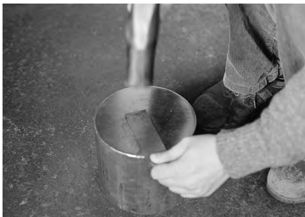
写真3 0.71ミリの鉄板を打ち延べる。
