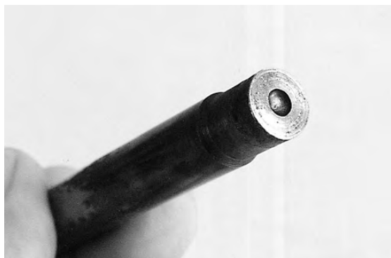
写真8 型鍛造用変形魚々子鑿
