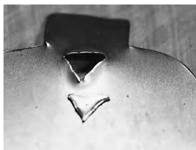
写真7 切断鑿で透かす（裏面）
