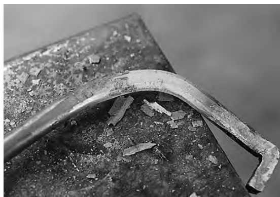
写真18 鍛接部の曲げ加工①
