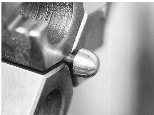
写真9 鋇頭部の曲面切削
