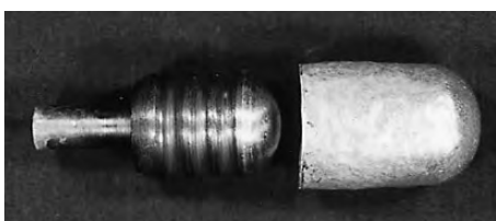
写真121 指貫形の胴回りをさらに絞る
