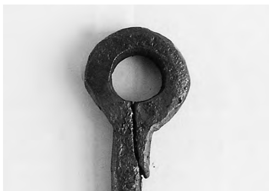
写真8 軸に沿わせるように鍛接部分の加工を行った
