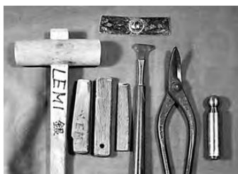
写真83 使用した工具類—左から木槓、木鑿3本、メノウペラ、金鋏、鑿
