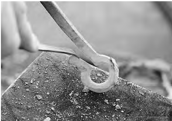
写真27 鍛接面の酸化膜を除去する
