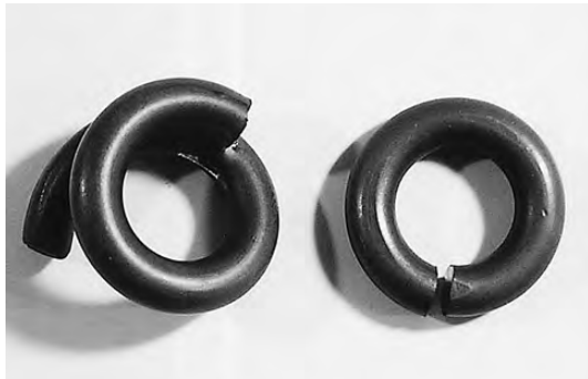
写真1 銅芯のスパイラル状曲げ加工
