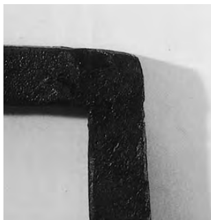
写真3 直角の型を用いた曲げ加工
