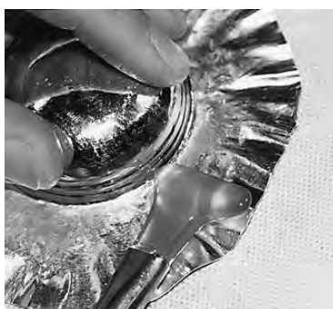
写真139 ヘラで沈線押し込む
