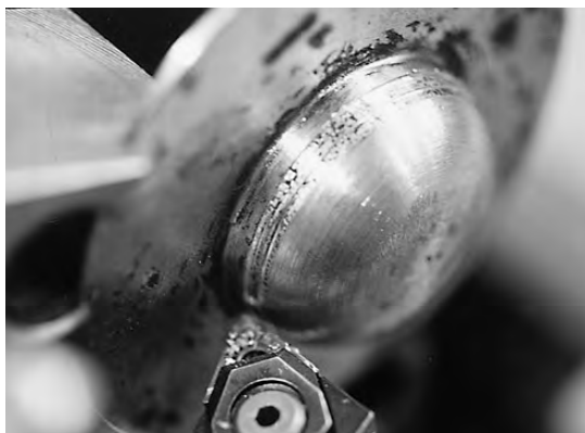
写真21 旋盤による沈線の加工
