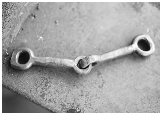
写真38 鍛接部分の整形を終えた状態
