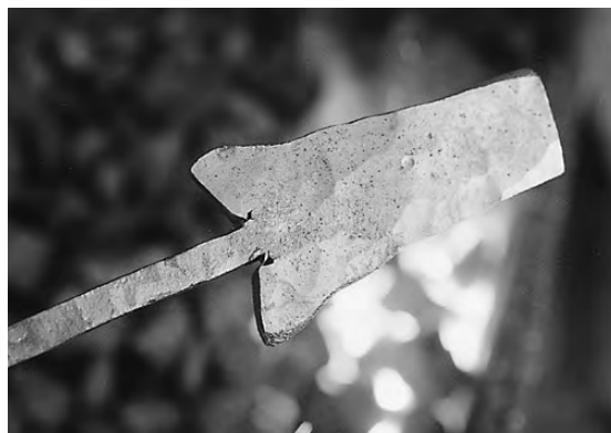
写真6 刃の幅が不足した実験品
