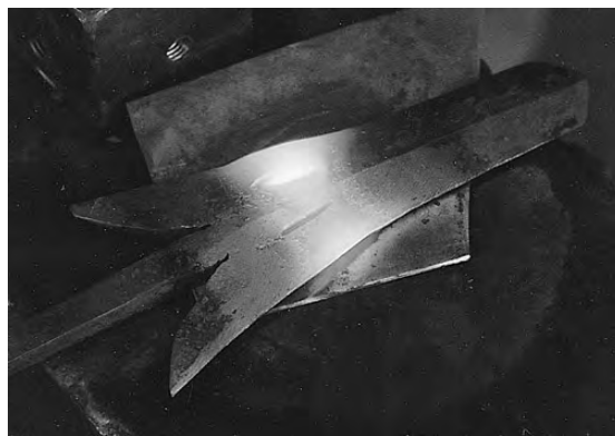
写真23 刃部分に変形が見られる
