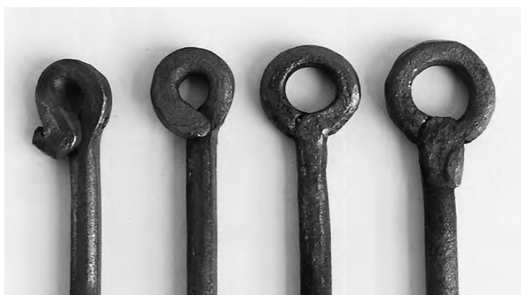
写真7 重ねて鍛接を行った実験品
