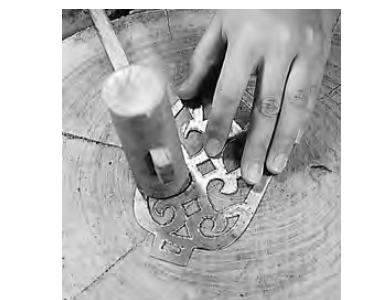
写真9 反った透し板を修正する
