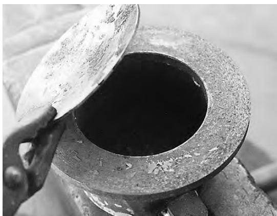
写真7 脚部分の鍛造用沿わせ型
