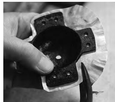
写真141 脚の形に沿って金銅板を切断する
