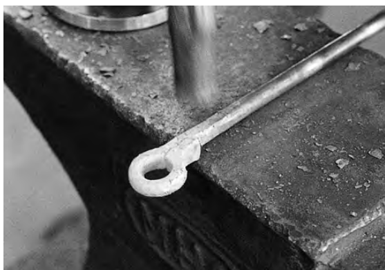
写真31 鍛接部の整形
