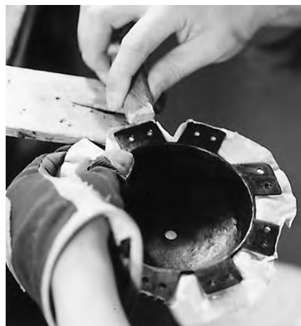
写真101 東西南北の4箇所を仮留めする
