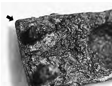
写真15 金銅板の折り返し（コーナーに皺が寄っている）
