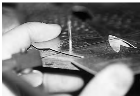
写真28 寸法に合わせてパイプを切断する
