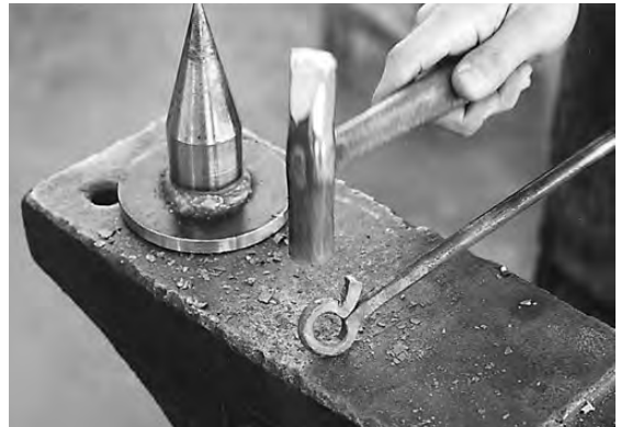
写真24 接合面の位置を修正する
