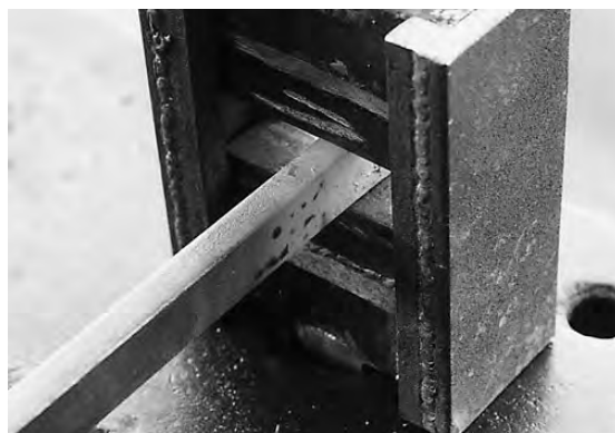
写真4 軸部分を階段状に鍛造する
