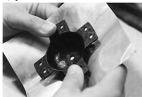
写真129 鉄地に金銅板を押し付ける
