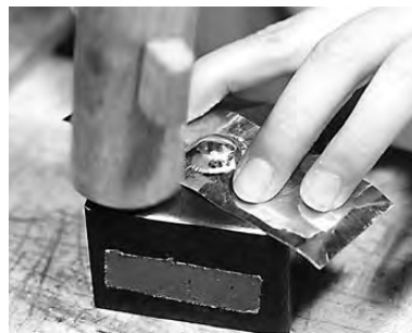
写真68 鉄地に金銅板を被せて叩く
