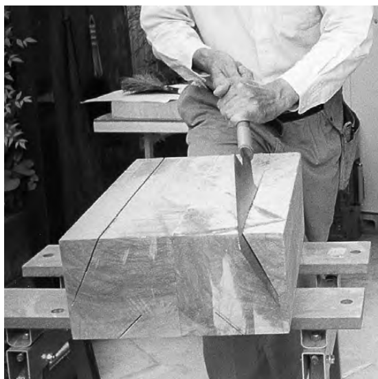
写真7 居木製作 外側加工(2)
