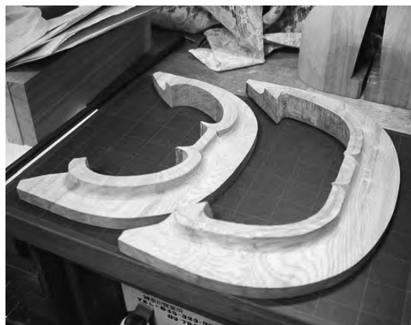
写真3 鞍橋製作ケガキ作業
