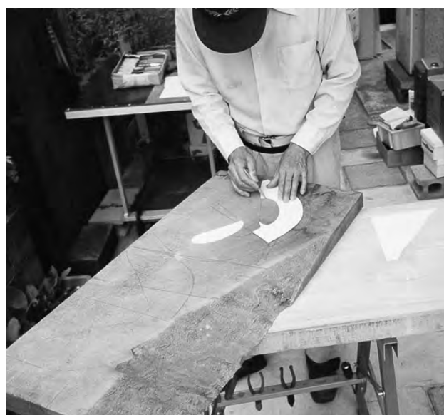
写真3 鞍橋製作ケガキ作業
