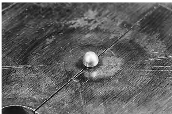
写真9 万力に固定して型鍛造を行う
