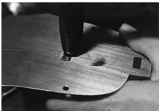
写真47 金槌によるかしめ加工
