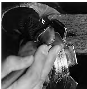
写真110 ヘラで金銅板を側面に倒す
