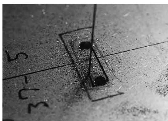
写真10 糸鋸での孔開け加工
