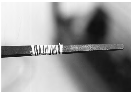
写真28 軸の太さの調整
