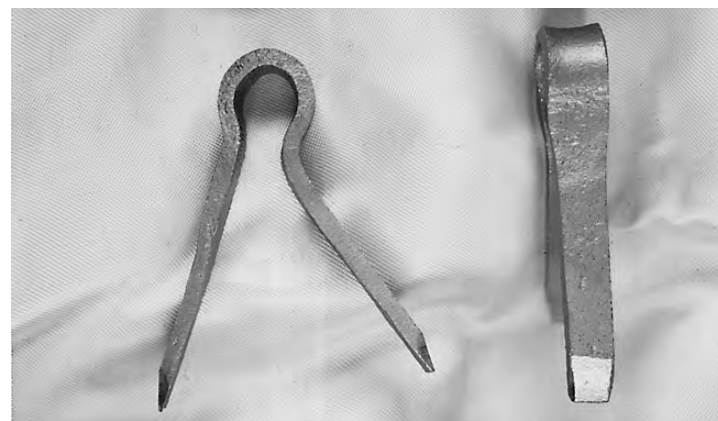
写真10 鞍本体と組み立て前の割ピンの状態
