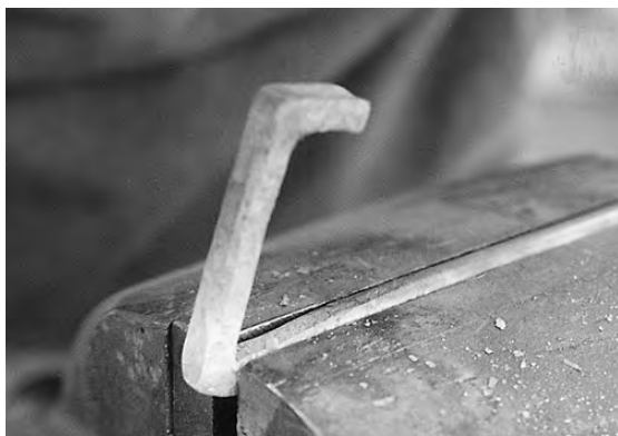
写真19 鍛接部の曲げ加工②
