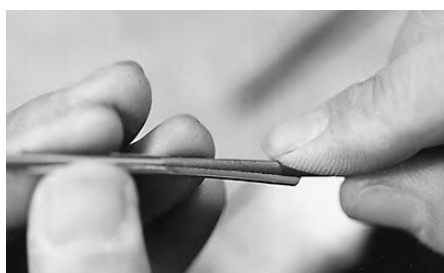
写真19 芯棒に金銅板を巻き付ける
