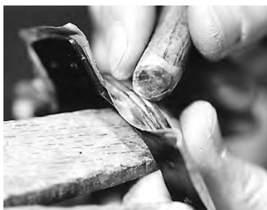
写真143 鉄地に沿って金銅板が延びる
