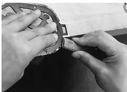
写真52 金銅板を側面に折り返す
