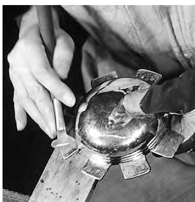
写真112 ヘラで沈線を押さえる
