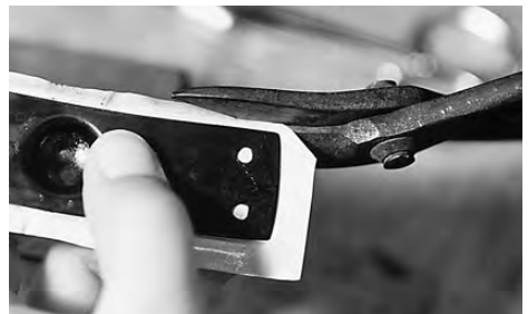
写真75 長辺部の金銅板を切断する
