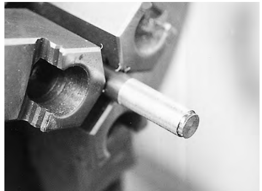
写真6 素材の鋼材丸棒（径10mm）
