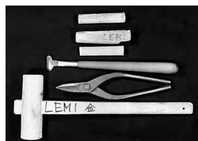
写真114 使用した工具類—上から木槌3本、メノウベラ、金鋏・木槌
