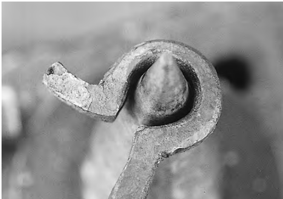
写真23 円錐形の金型での曲げ加工②
