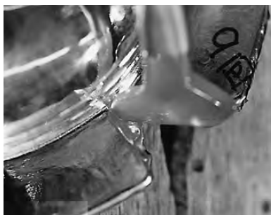
写真109 ヘラで脚の間の金銅板を延ばす
