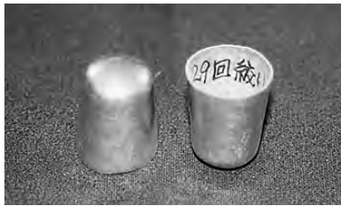
写真155 29回目の絞り加工
