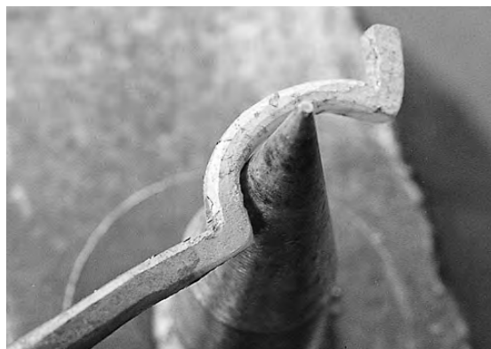
写真22 円錐形の金型での曲げ加工①
