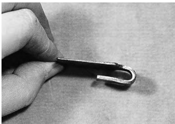
写真2 鉤部分を曲げる。
