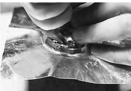
写真137 ヘラで側面を押さえる
