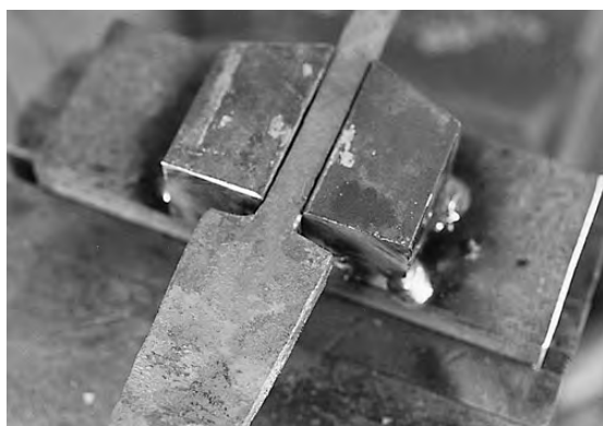
写真16 軸と刃の境目を直角にする
