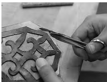
写真46 余分な地金を切り落とす
