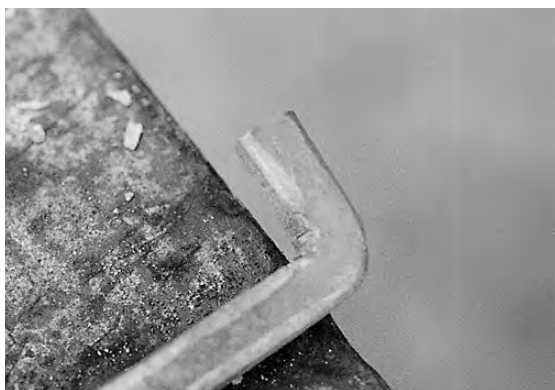
写真15 金床での曲げ加工
