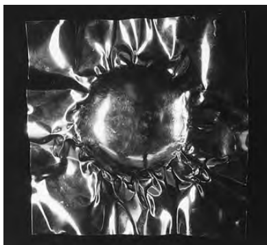
写真88 表側から木槓で叩き、鉄地の形に沿わせる
