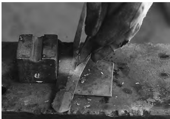
写真22 鋸での切り込み
