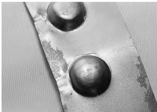
写真10 受け型の孔の跡が残ってしまった状態。
