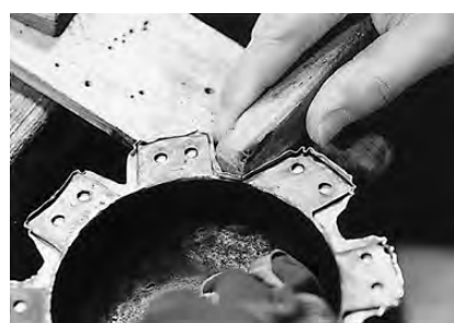
写真106 金銅板を脚の側面に折り返す
