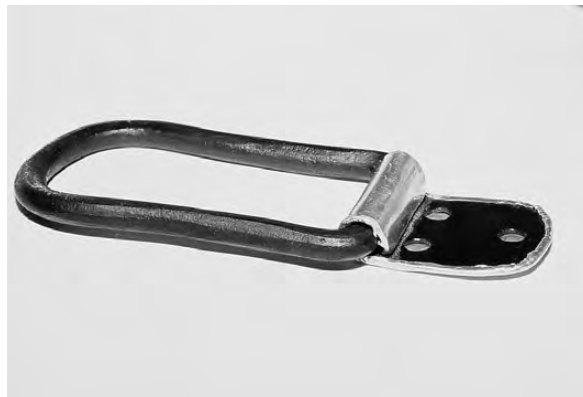
写真4 帯金具を取付けた締金具（裏）
