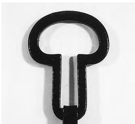
写真9 漆焼きで仕上げた状態
