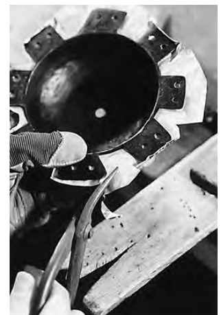
写真102 脚部に合わせて切断する
