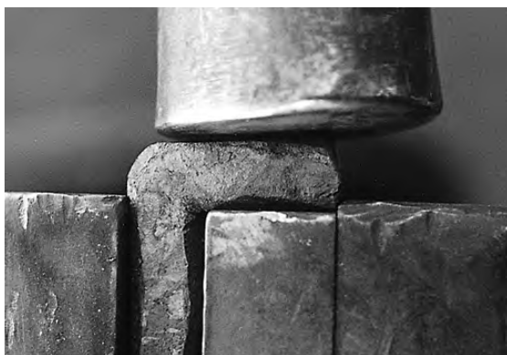
写真17 角部分の据込み加工
