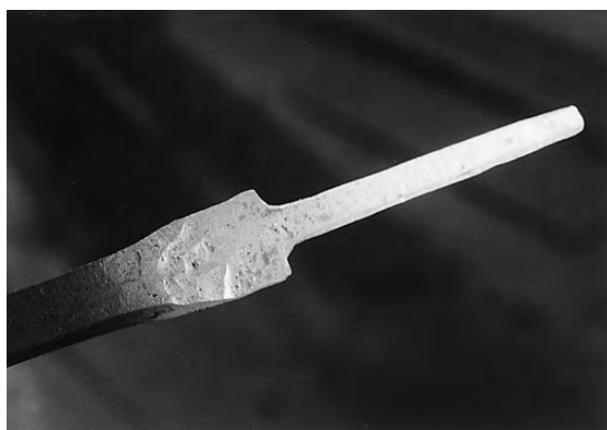
写真14 軸部分の成形
