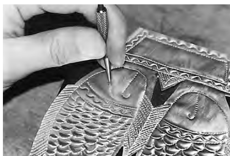
写真25 目玉の取り付け位置に石目鑿を打つ
