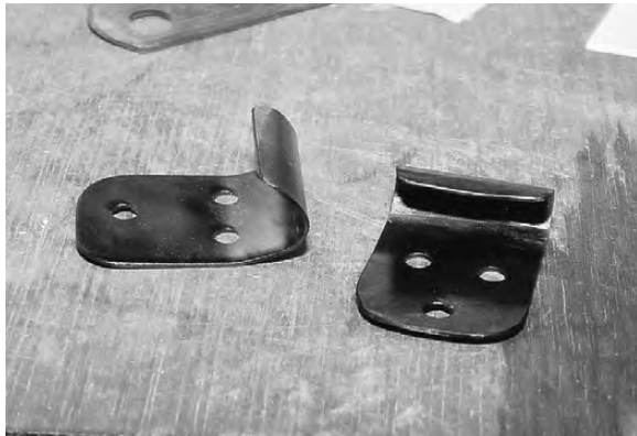
写真1 曲げた状態で漆焼きをする。
