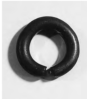
写真2 銅芯切断後、曲げ加工
