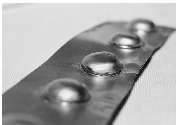
写真12 打出しの衝撃で半球形の周囲が切れた状態。
