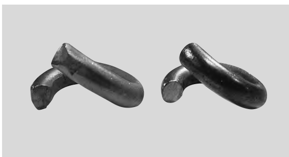
写真13 左：中央部より曲げ加工後、両端部を曲げたサンプル 右：両端部を先に曲げた後、全体を曲げ加工したサンプル（断面形状を比較しやすくするため成形後、環をねじった。）
