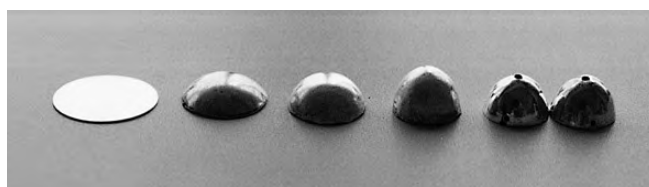
写真3 半球形に打ち出して空玉の半身を作る
