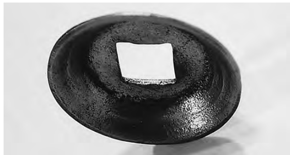
写真13 座金復元品の開口部の入り込み
