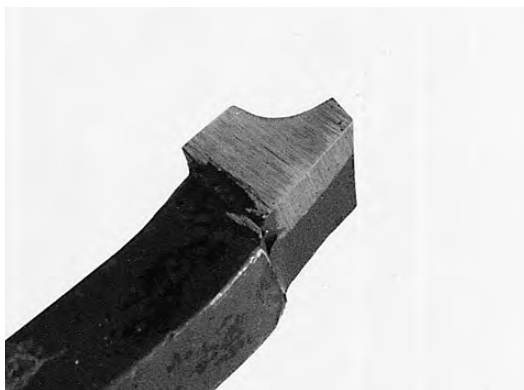
写真11 旋盤用バイトの加工
