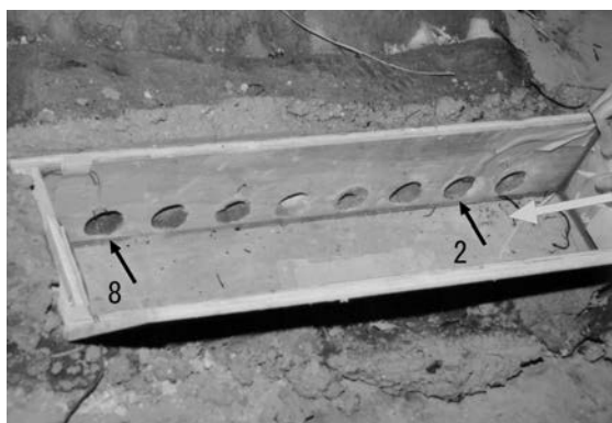
写真5 風箱内のセンサ設置状況
