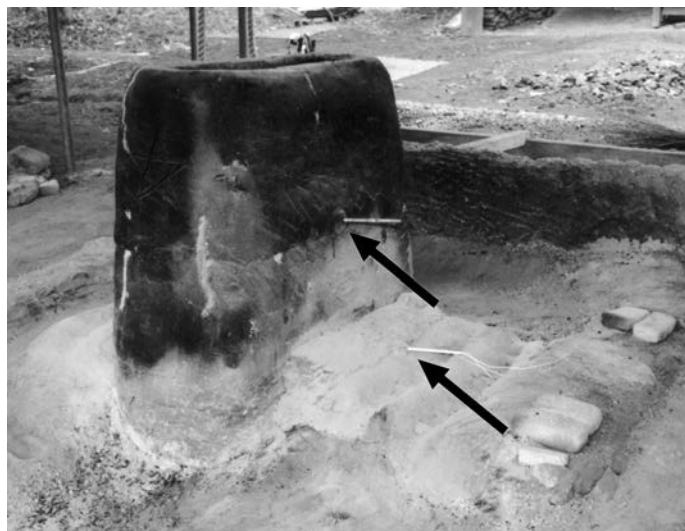
写真1 炉の外観と熱伝対の設置位置
