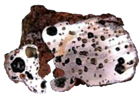
横大道製鉄遺跡(南相馬市) 出土鉄塊の切断面写真
