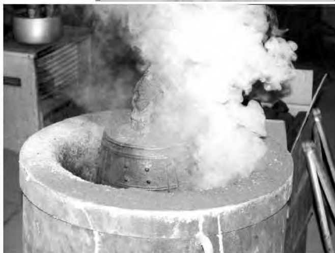
③ 仮称稲藁燻し法 (稲藁を低温で燃やし、その煙でコーティングする。)
