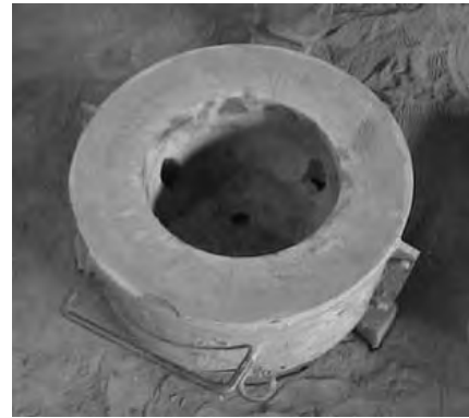
図 35、36 獣脚の鑄型を埋け込む為の孔をあける
