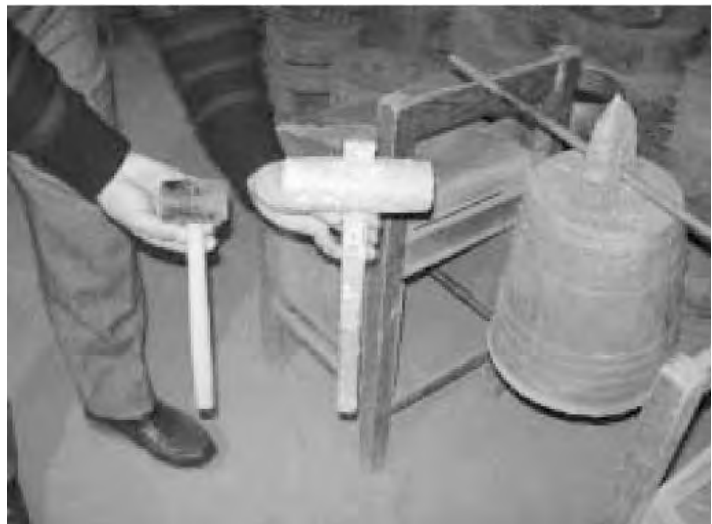
図4 試作2号鐘と使用したハンマー（左：ゴムハンマー、右：木ハンマー）
