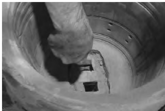
図 23 外型に竜頭の鑄型を埋け込む
