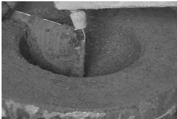
図 83、84 第二層の中真土を挽く
