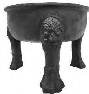
獣脚付容器(獅嚙タイプ) →仮称炭焼き法(蜜蝋仕上げ) 原料：玉鋼30%+ 鉄鉱石ズク70%
