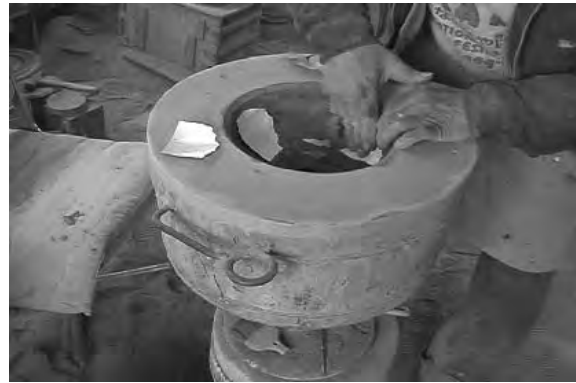
図 85、86 獣脚の鋳型を埋け込む孔の上部に紙を充てて補強
