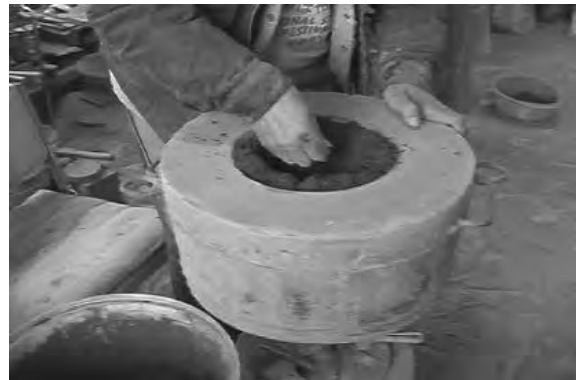
図 88 荒真土を充填する
