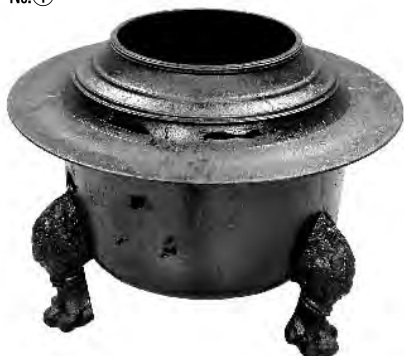
獣脚付容器(羽釜タイプ) 1回目鋳込み→油焼き法 原料：玉鋼30%+鉄鉱石ズク70%
