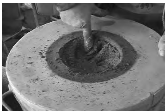
図 91、92 中子の内側に凹凸をつける
