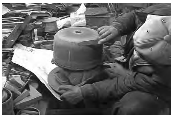
図 46, 47 中子の表面を削り取る
