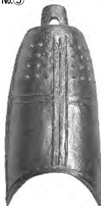
2号風鐸(乳付き) 2回目鋳込み →金箔貼り仕上げ 原料：玉鋼50%+鉄鉱石ズク50%
