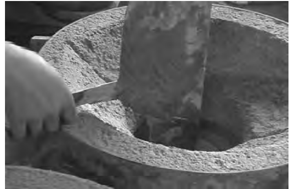
図11、12 「うま」と「とりめ」で挽き型を固定する
