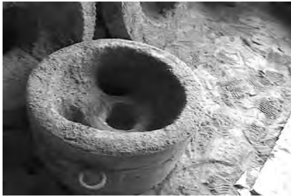
図 80 下地の荒真土を張り付ける
