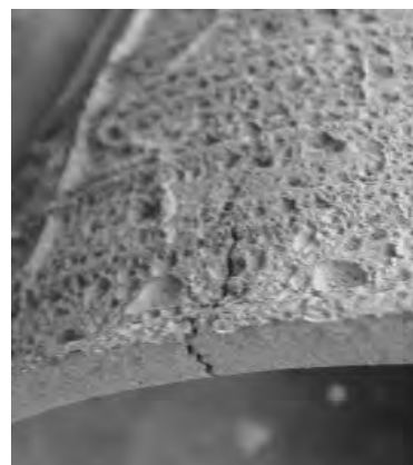
図42 口唇部のひび割れ
