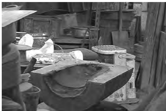
図 70 中真土の充填が終了
