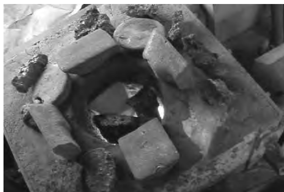
図 57 ズクの溶解（電気炉による）
