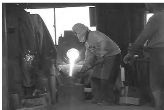
図 29 溶けた鉄をとりべに取る
