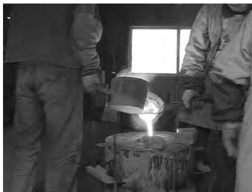
図 60 とりべからとりべへ湯を継ぎながら铸込む
