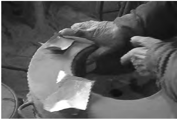
図 85、86 獣脚の鋳型を埋け込む孔の上部に紙を充てて補強
