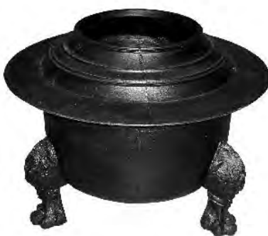
獣脚付容器(羽釜タイプ) 2回目鋳込み→漆焼き法 原料：玉鋼50%+鉄鉱石ズク50%
