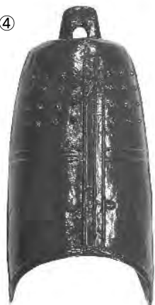
2号風鐸(乳付き) 1回目鋳込み →赤漆塗り仕上げ 原料：玉鋼30%+鉄鉱石ズク70%
