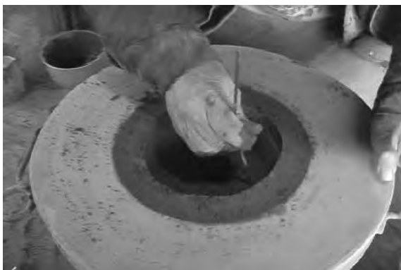
図 89 荒真土を充填する
