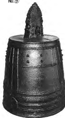
梵鐘 3回目鋳込み→漆焼き法 原料：玉鋼90%+鉄鉱石ズク10%
