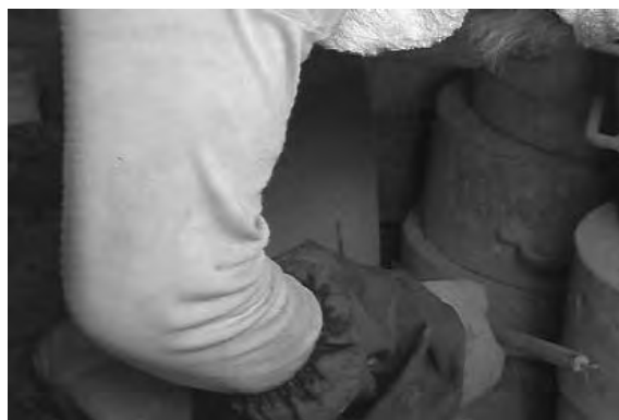
図 26 中子のヒビを修正する
