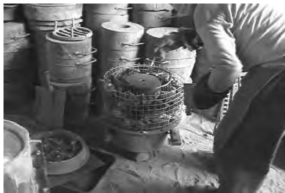
図 24 中子を焼成し乾燥させる
