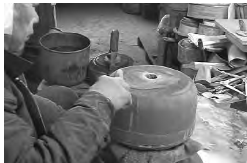
図45 中子の表面を削り取る
