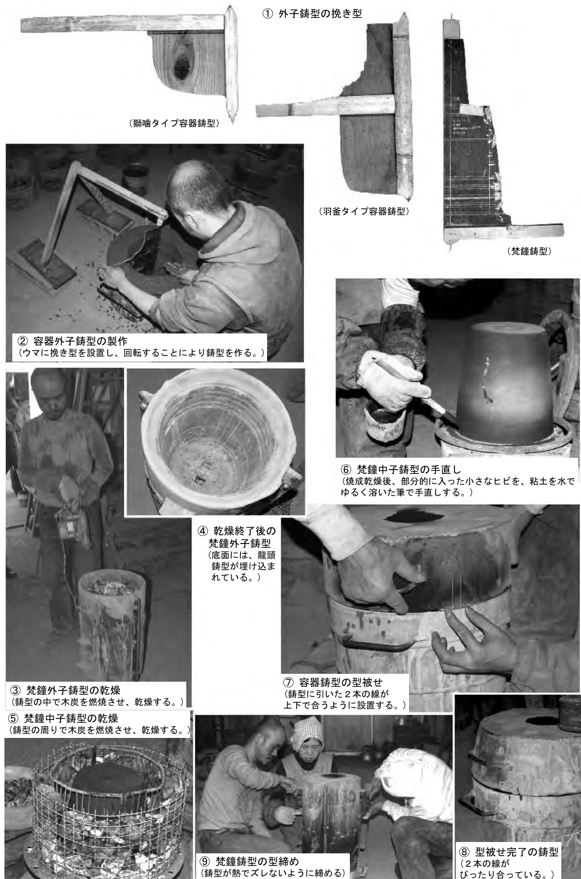
写真3 鑄型製作から鑄型設置
