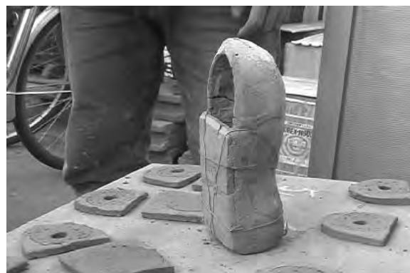
図34 張り合わせて埋め込み型とする
