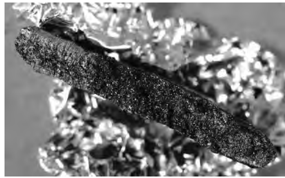
図 11 梵鐘 3 の堰の破面
