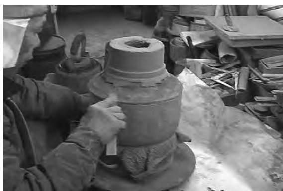
図 46, 47 中子の表面を削り取る
