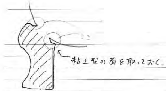
図 37、38 底型の三方に位置を決めて空洞を開け、焼成した獣脚の型を埋け込む (位置を決め、埋めるとき、底の曲面に沿うように接合面を整える。その時、挽き型を挽いてできた曲面と交わるところは、埋け込み型の接合面の「面」をとっておくと整えやすくなる)
