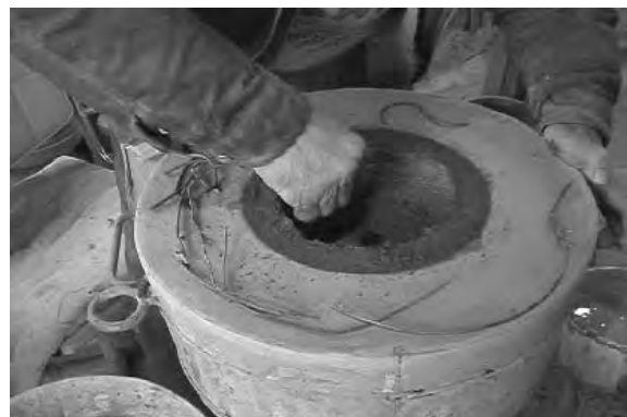
図 90 荒真土を充填する
