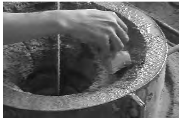
図13、14 第二層の真土（荒真土）を挽く前に「はじる（粘土で水を溶いたもの）を刷毛で塗る
