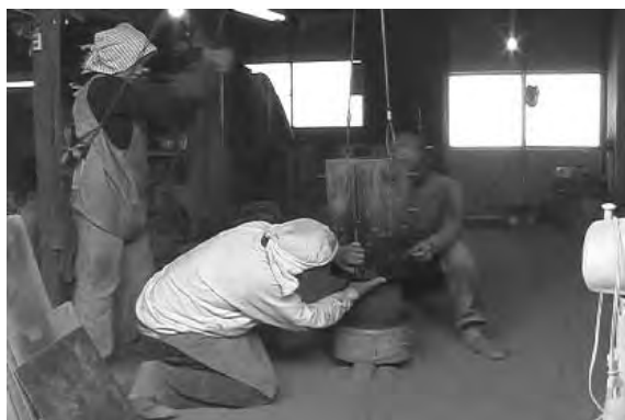
図 27 鑄型を組み上げる
