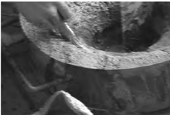
図13、14 第二層の真土（荒真土）を挽く前に「はじる（粘土で水を溶いたもの）を刷毛で塗る
