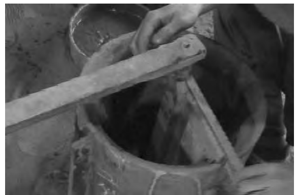
図 16 挽き型を使って真土を挽く
