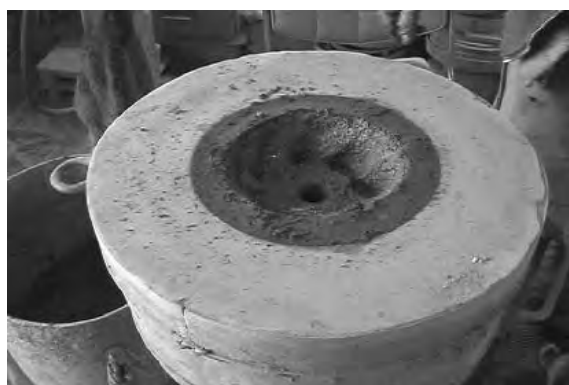
図 91、92 中子の内側に凹凸をつける
