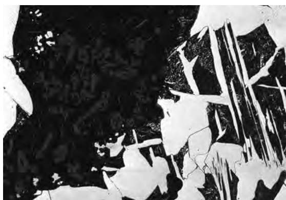
写真 61 資料 No. 2 薄皮状の金属鉄部分顕微鏡写真 × 400
