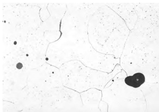
写真 58 資料 No. 2 薄皮状の金属鉄部分顕微鏡写真 × 100
