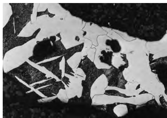
写真 56 資料 No. 2 薄皮状の金属鉄部分顕微鏡写真 × 50
