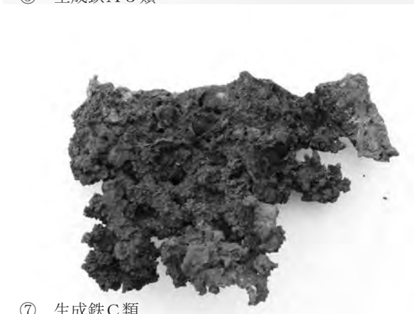
写真9 3号炉小割り作業と生成鉄
