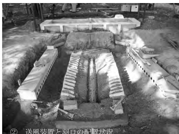
② 送風装置と羽口の配置状況
